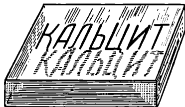
106- расм. Кальцит кристалида нурнинг иккиланиб синиши.
