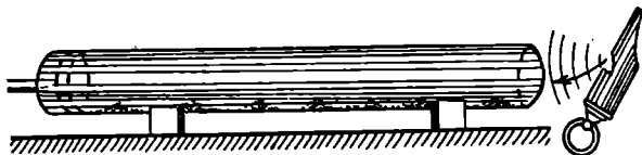
85-расм. Турғун тўлқинларнинг найдаги кукунга таъсири.
