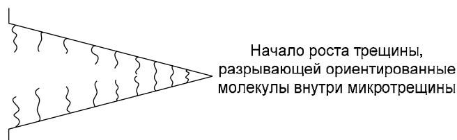
Рис.25. Схема роста трещины полимера, находящегося в стеклообразном состоянии
