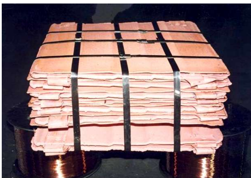
5- rasm. Elektroliz sexidan chiqqan va sotuvga tayyorlangan 99,99 % li mahsulot – mis katodining umumiy ko‘rinishi.
