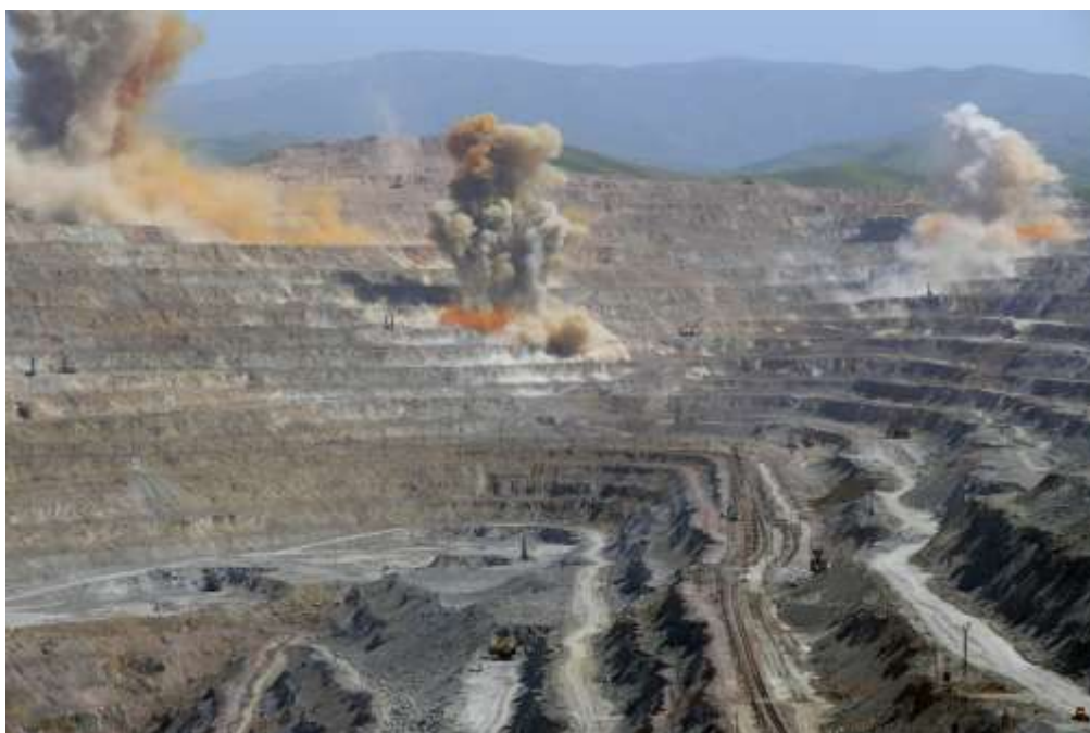
3-rasm. Markaziy Osiyoda eng yirik mis qazib olish konlaridan biri Qolmoqqir makonidagi rudalarni portlatish jarayoni.
