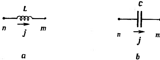
Рис. 4.8. В формулах (4.13) и (4.14) j = j_{nm} , v = v_{nm} ; разность потенциалов берется по направлению j .
