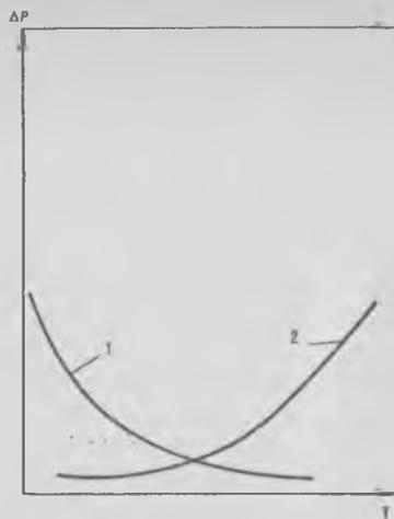
Рис. 3.11. Влияние температуры на изменение пластичности  $\Delta P$  при механической (1) и термоокислительной (2) деструкции
