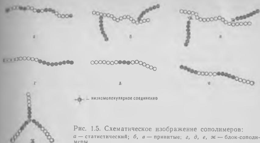
Рис. 1.5. Схематическое изображение сополимеров: а — статистический; б, в — привитые; г, д, е, ж — блок-сополимеры
