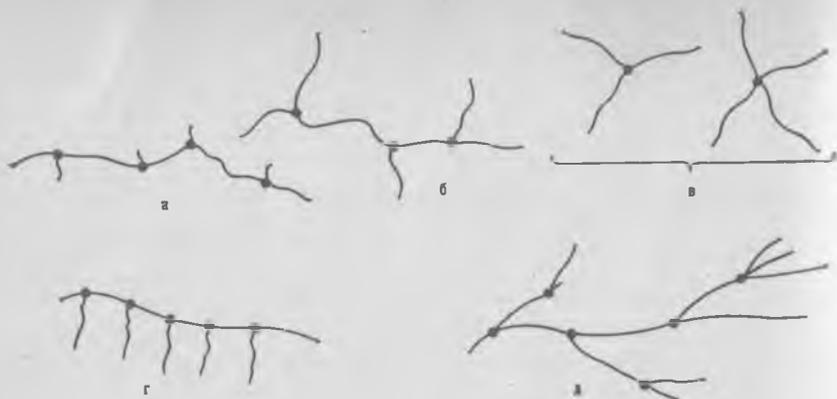
Рис. 1.6. Схематичное изображение разветвленных полимеров: а — с короткими боковыми цепями; б — с длинными боковыми цепями; в — регулярные звездообразные трех- и четырехлучевые; г — гребнеобразные; д — статистические
