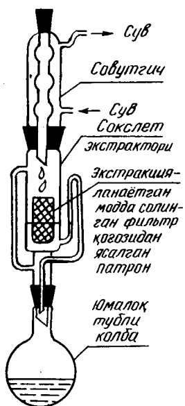
7- расм. Сокалет экстрактори каттик моддани эритувчи билан ёрдамида моддаларни ажратиш асбоби
