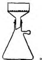
1.11 расм. Воронкалар: а — оддий шиша воронка; б — чинни воронка; в — Шотта воронкаси; г — вакуумда филтрлаш воронкаси
