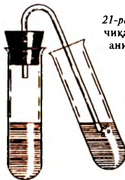
20-расм. Реакцияда ҳосил бўладиган газларни аниқлаш асбоби.
