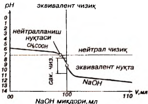
37-расм. \text{CH}_3\text{COOH} нинг 0,1 н эритмасини \text{NaOH} нинг 0,1 н эритмаси билан титрлаш эгри чизиғи
