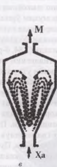
2.84-расм. Муаллак гетероген-каталитик жараён учун реакторлар схемаси (Ха - хом ашё, М - маҳсулот, Ц - циклон).
