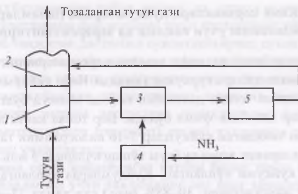
6.24-расм. Тутун газларини азот оксидларидан тозалаш схемаси: 1 – дудбурон; 2 – тўсиқ; 3 – аммиакни тутун газин билан аралаштиргич; 4 – аммиакни дозалаш блоки; 5 – реактор.
