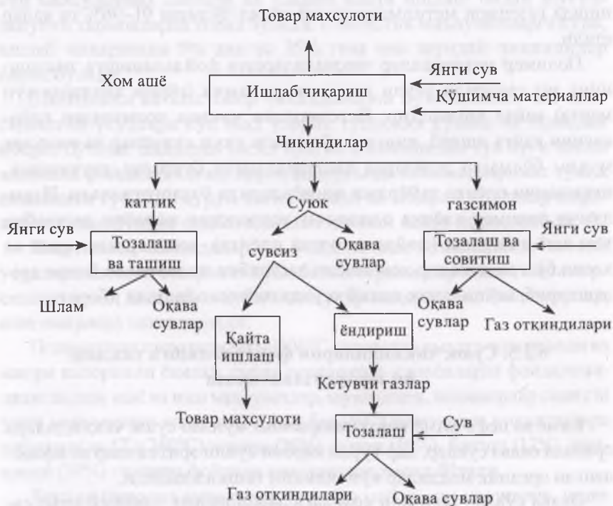
6.16-расм. Кимёвий ишлаб чиқаришда оқова сувларнинг ҳосил бўлиш схемаси.
