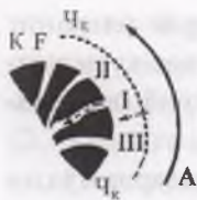
2.31-расм. Гетероген каталитик кимёвий жараён схемаси ва структураси. К катализатор; F катализатор ғоваклари; Ч к – чегара кават; I, II, III – жараён босқичлари.
