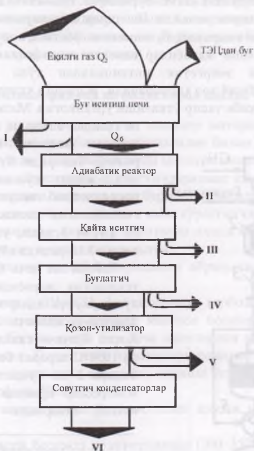
3.14-расм. Этилбензолни дегидрирлаш агрегатидаги иссиқлик оқимларнинг диаграммаси: I – буг иситиш печидаги тутун газларидан йўқолувчи иссиқлик; II – дегидрирлашдаги эндотермик реакция компенсациялаш; III – этилбензол шихтасини иситиш; IV – этилбензолни буглатиш; V – сув бугини генерирлаш; VI – совутиш ҳавоси ва хладагент билан атроф-муҳитга йўқолувчи иссиқлик.
