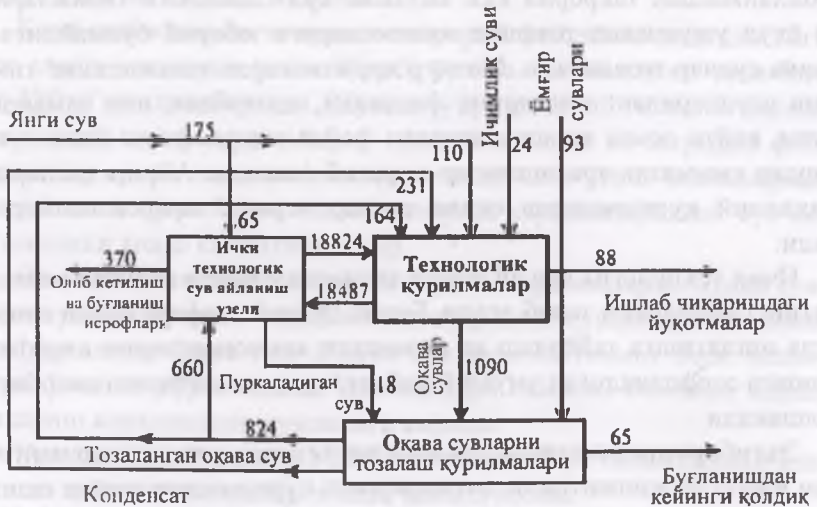
6.11-расм. Нефтни қайта ишлаш заводларида сувдан фойдаланиш схемаси (рақамлар м 3 /соат ҳисобидаги сарфни кўрсатади).
