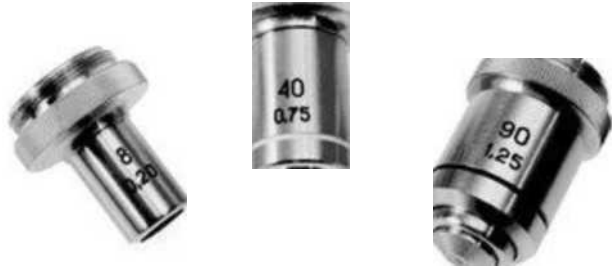
Yorug'lik mikroskopi uchun okulyar va ob'ektivlar
