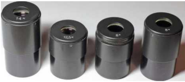
Yorug'lik mikroskopi uchun okulyar va ob'ektivlar
