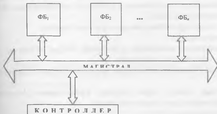
18.2-rasm. AO'T magistral struktura sxemasi
