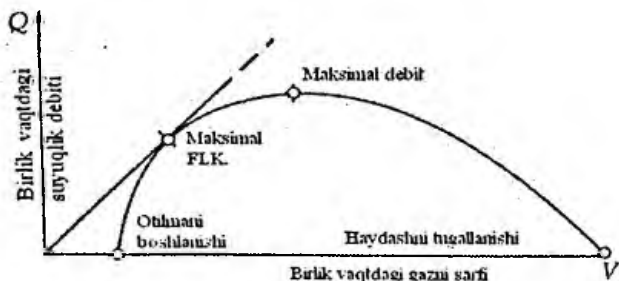
5.8-rasm. Suyuqlik debitining gaz sarfiga ( V ) \xi=const bo'lgandagi bog'lanish grafiği (Ko'targich diametri d_k = 73 mm)
