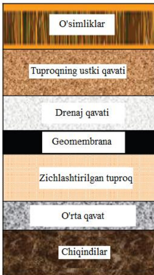
102 rasm. RCRA D-bandida qabul qilingan poligonni yopish tizimi Na'munaviy sxemasi
