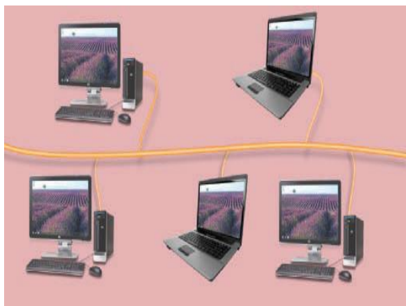
6-rasm. SHina topologiyasida kompyuterlarni ulanishi
