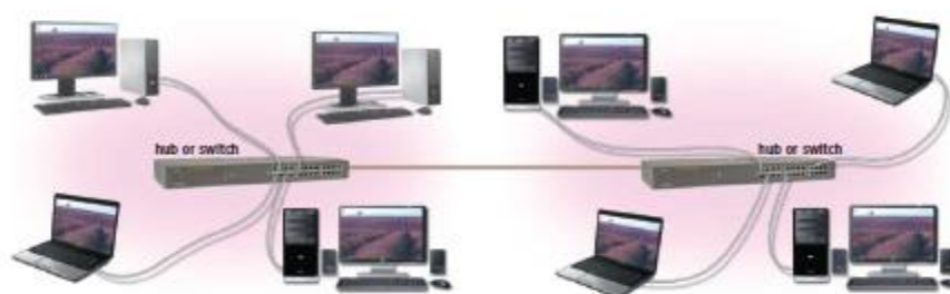
8-rasm. Konsentrator yoki kommutator orqali tarroqqa ulanish
