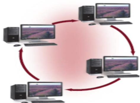
5-rasm. Xalqa topologiyasida kompyuterlarni ulanishi
