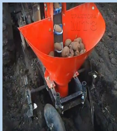
40-rasm. Kartoshka ekish seyalkasining umumiy ko'rinishi va ish jarayoni
