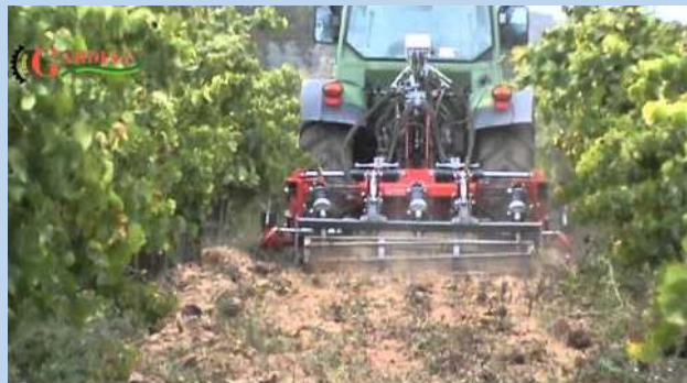
45-rasm. Bog‘ kultivatorlariining ush jarayoni
